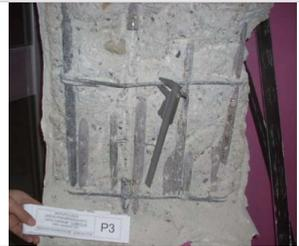
**Figura 6:** Estrazione di barra di armatura da pilastro in c.a.
