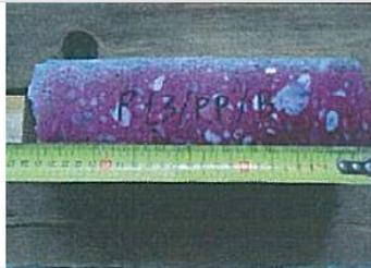
**Figura 5:** Prova di carbonatazione su provino di calcestruzzo
