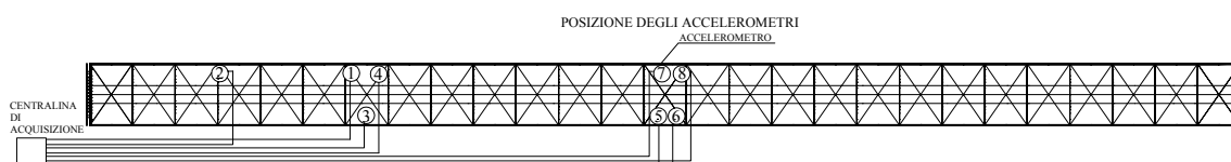
Fig. 13 - Posizione degli accelerometri sul ponte
