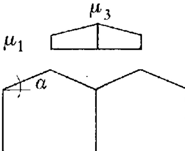
Particolare attenzione dovrà essere prestata per la scelta del coefficiente di forma  $\mu_3$  quando una o entrambe le falde hanno inclinazione superiore a  $60^\circ$ .
